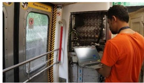
2. 港鐵公司及承辦商人員使用針對市區綫信號系統更換工程而設的「列車測試模擬系統」模擬測試大量不同情景。
